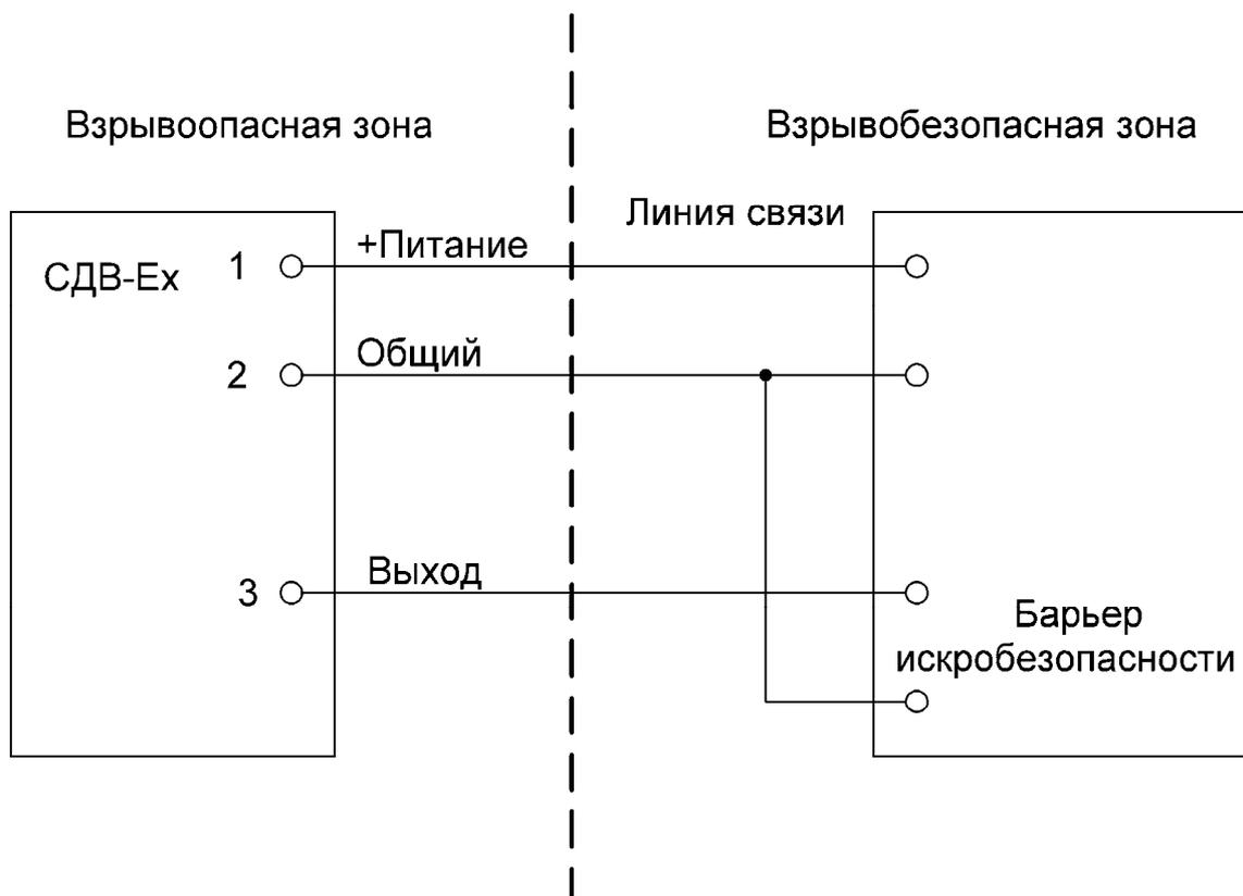
Рисунок В.4 — Схема подключения преобразователей взрывозащищенного исполнения
