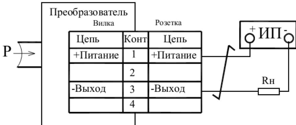
Рисунок В.1 — Схема подключения преобразователей общепромышленного исполнения с кодами 10, 13, 60 по таблице А.10
