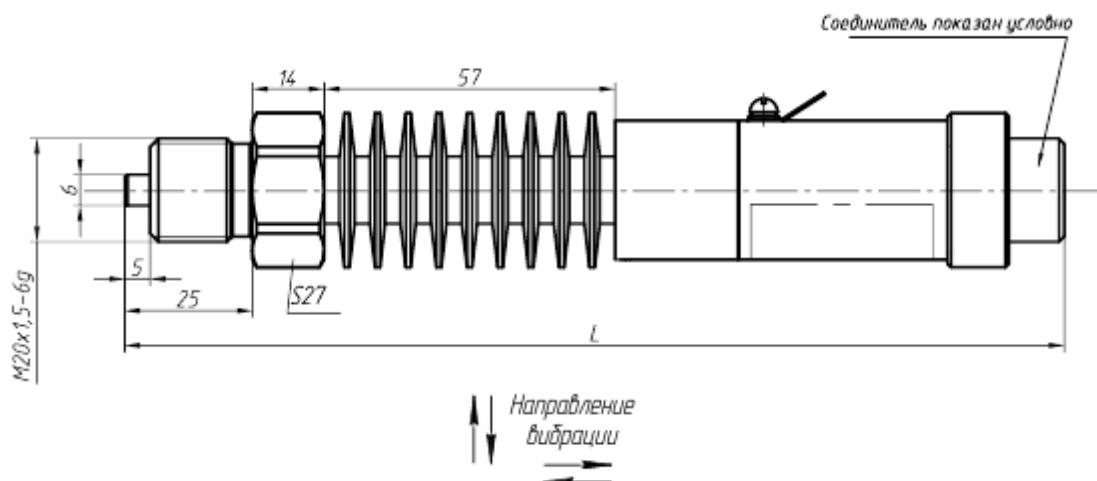
Рисунок Б.9 — Габаритный чертёж преобразователей избыточного давления, разрежения, давления-разрежения исполнения ВТ2 с кодом присоединительного размера 2 (по таблице А.8) и кодом конструктивного исполнения К20, К34 (по таблице А.14)
