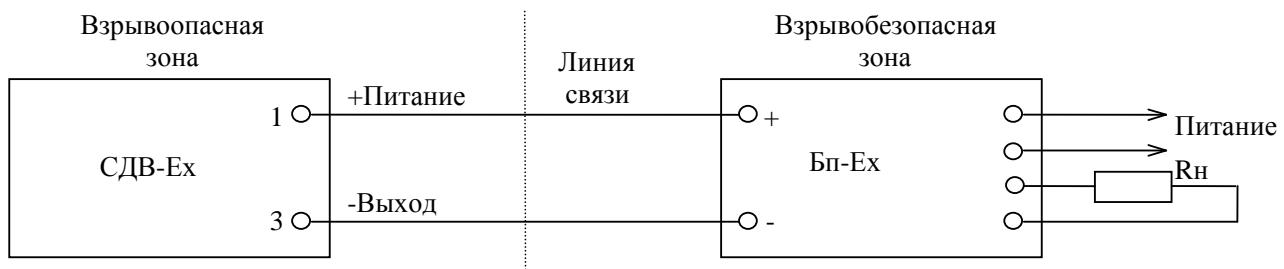
Бп-Ex — искробезопасный блок питания
