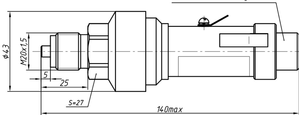
П р и м е ч а н и е — Винт заземления присутствует только в исполнении СДВ-Ex.
