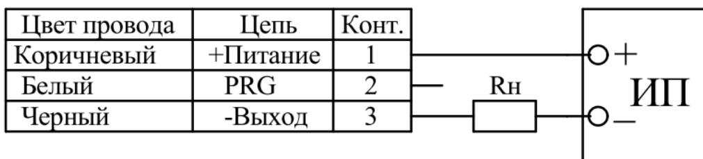
Соответствие назначения выводов разъёма цветовой маркировке проводов кабеля (исполнения 91, 92 по таблице А.10)
