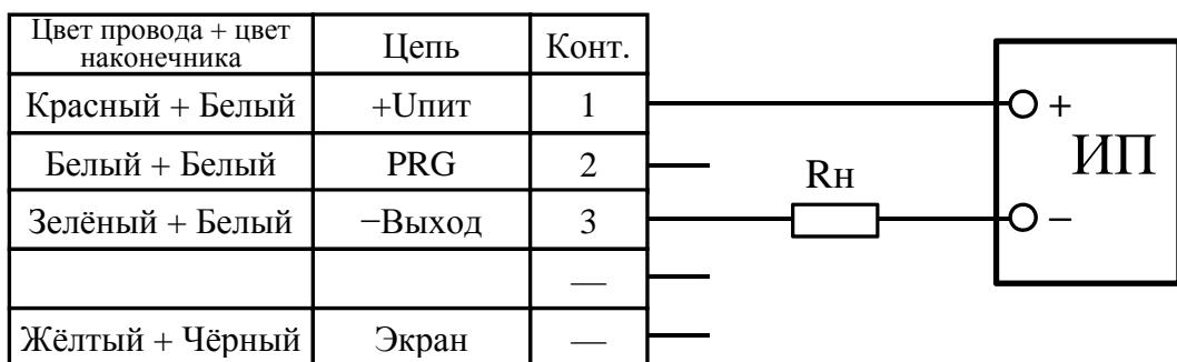
Соответствие назначения выводов разъёма цветовой маркировке проводов экранированного кабеля преобразователей гидростатического давления (исполнение 93 по таблице А.10)
