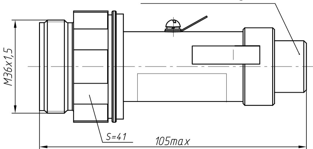
П р и м е ч а н и е — Винт заземления присутствует только в исполнении СДВ-Ex.
