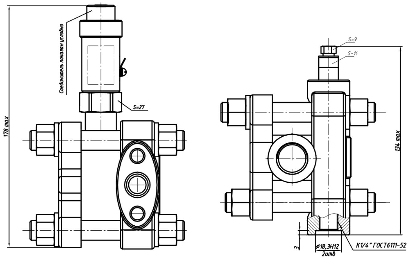
П р и м е ч а н и е — Винт заземления присутствует только в исполнении СДВ-Ex.
