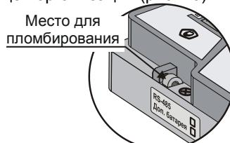
Рис. 1.3 – Место пломбирования инспектором
