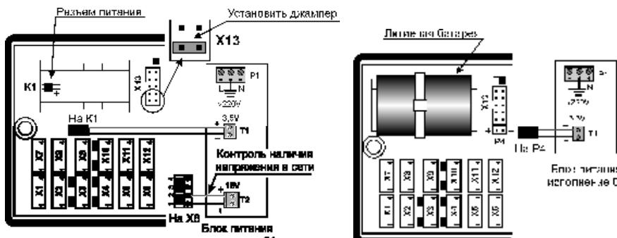
Рис. Н.3 – Схема подключения блока сетевого питания
