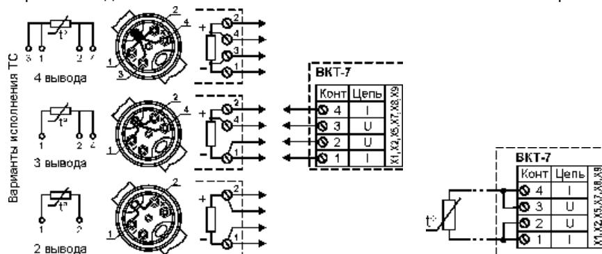
а) Подключение ТС по 4-проводное схеме
