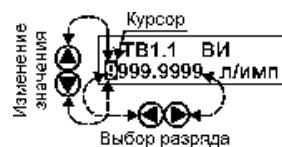
Рис. 3.2 – Пример изменения значения параметра ВИ
