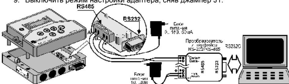
Рис. D3 – Схема подключения адаптера интерфейса RS-485
