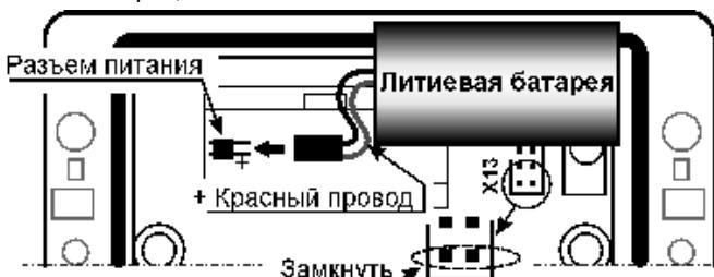
Рис. Л1 – Порядок подключения батареи
