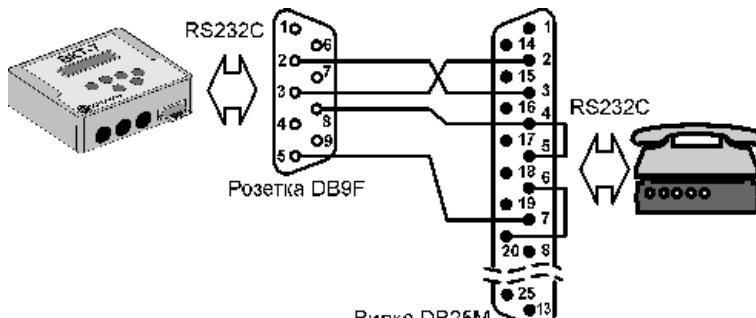
Схема подключения модема с разъемом DB25M
