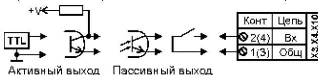
В случае пассивного типа выхода следует установить перемычку (джампер), показанную на рис. 5.3 слева от соответствующего разъема X3, X4 и X10, а при активном – снять ее.
