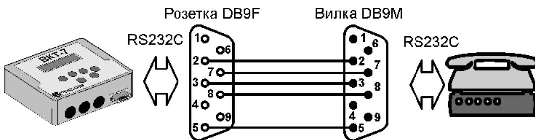
Схема подключения модема с разъемом DB9M
