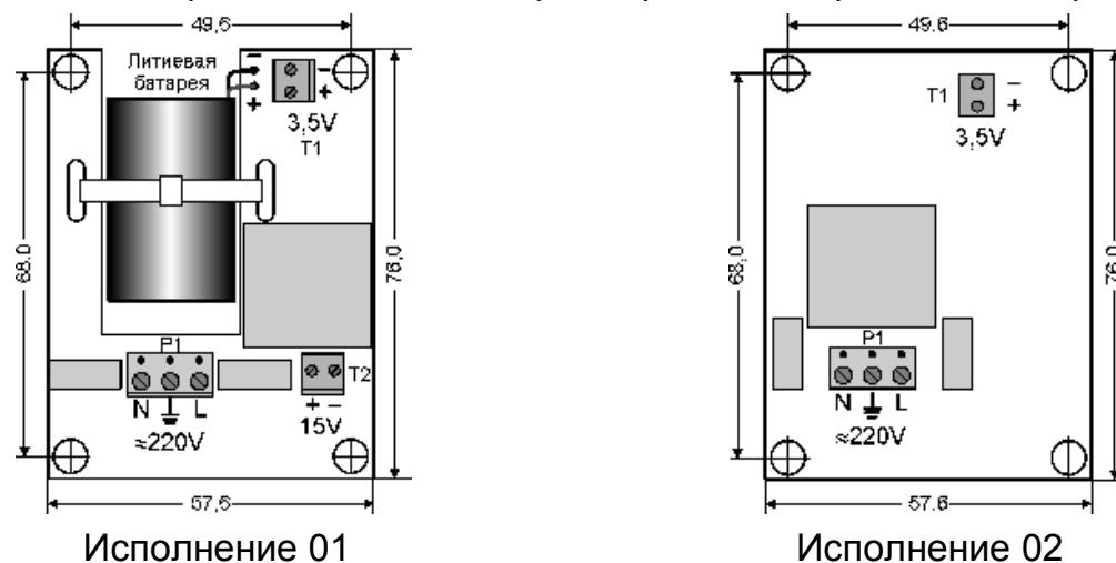
Рис. Н.1 – Внешний вид блока сетевого питания
