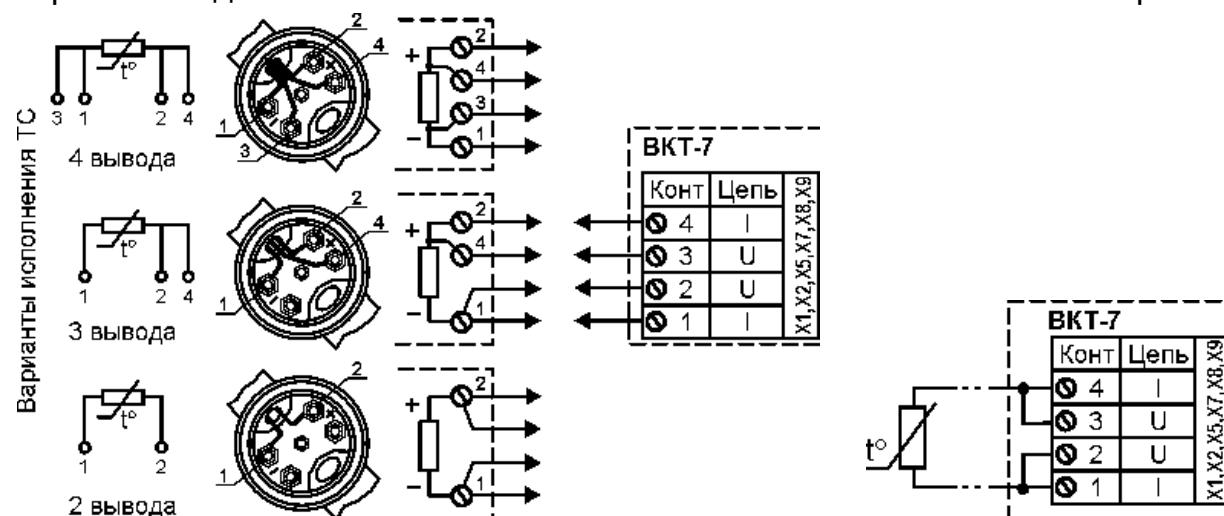
а) Подключение ТС по 4-проводное схеме
