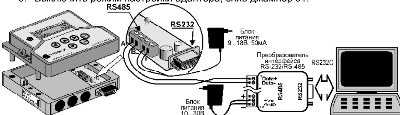
Рис. Д3 – Схема подключения адаптера интерфейса RS-485
