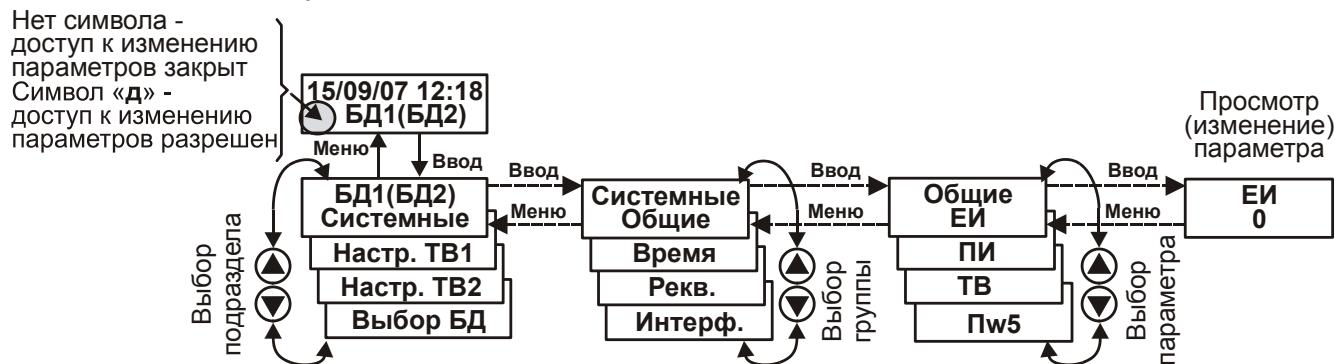
Рис. 3.1 – Пример просмотра значения параметра **ЕИ**
