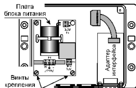
Рис. Н.2 – Схема установки блока сетевого питания
