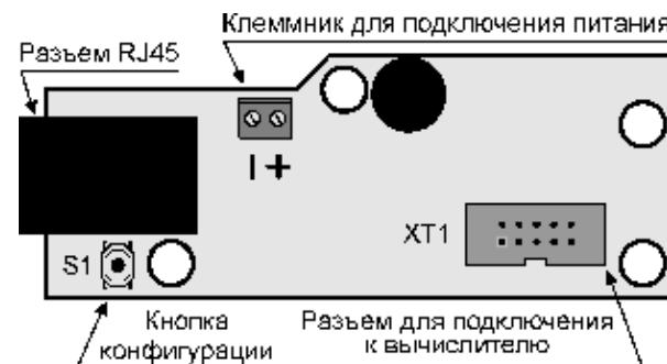
Рис. М.1 – Внешний вид платы адаптера Ethernet
