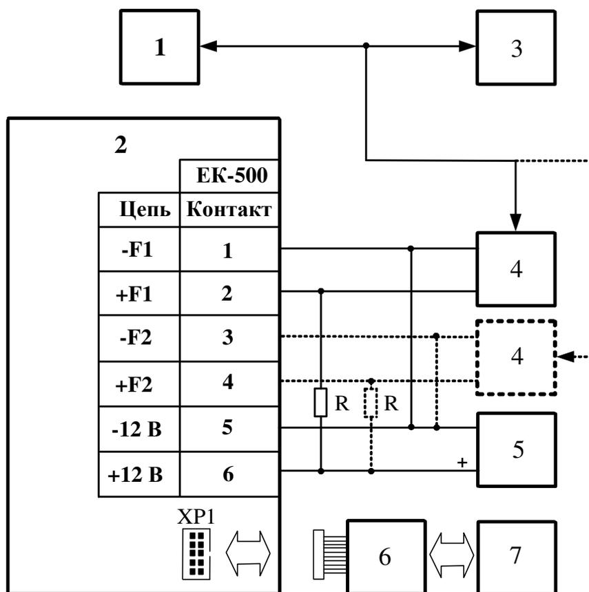
1 – контрольно-измерительная аппаратура установки поверочной; 2 – преобразователь расхода; 3 – секундомер-таймер; 4 – частотомер или счетчик импульсов, адаптированный к подключению пассивных входов; 5 – блок питания преобразователя; 6 – адаптер цифрового интерфейса; 7 – персональный компьютер с сервисным программным обеспечением “Калибр”; R – резистор МЛТ-0,125 номиналом 10 кОм.
