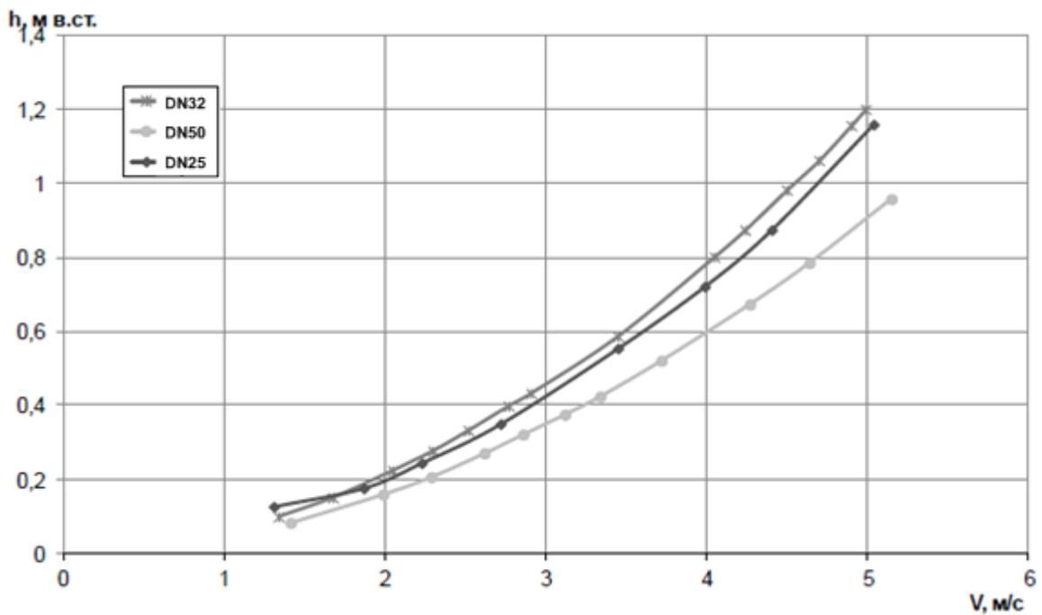
Рис.7. График зависимости падения давления от скорости потока при использовании расходомеров с прямоугольными вставками.
