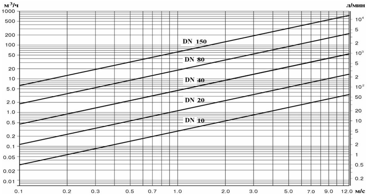
Рис.6. График зависимости расхода жидкости от скорости потока для различных значений DN.
