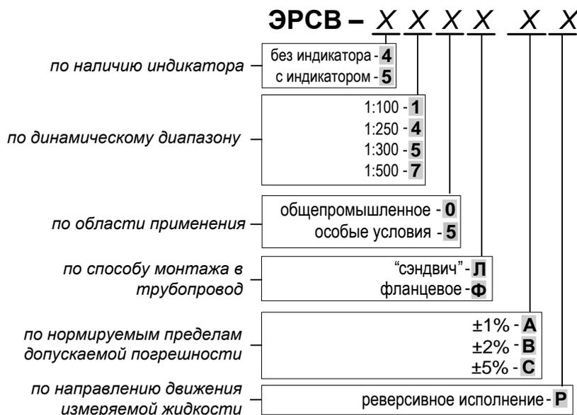
**Рис.1. Структура буквенно-числового кода типовых исполнений электромагнитных расходомеров модификации Лайт М.**
